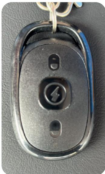
**1. Função Antifurto:** Com a bicicleta estacionada aperte o **botão bloquear** “”. Após isso a mesma irá soar um alerta sonoro, indicando o acionamento do alarme. Nesse modo o alarme é disparado quando a scooter for movimentada. A bicicleta pode ser desbloqueada para uso com o **botão desbloquear** “”.
