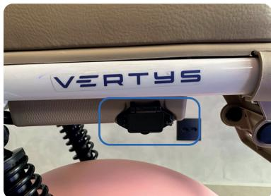
2. Plugue o cabo do carregador conforme ilustrado acima pressione até o final. Certifique-se quanto ao perfeito encaixe conferindo a firmeza da conexão.
